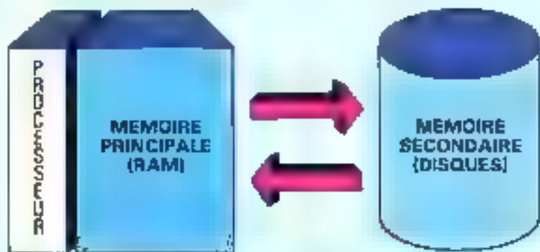
Fig. 12. - Le swapping est un va-et-vient entre disque et mémoire centrale qui simule une mémoire unique gigantesque.
